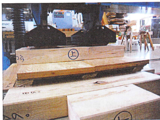
写真 2 段ボール紙製パレットの圧縮破壊 (写真左：試験機正面，写真右：試験機左側面)
